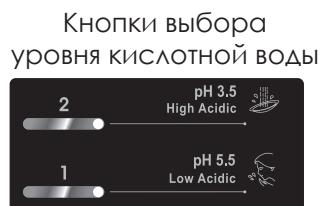
После выбора режима кислотной воды из шланга щелочной воды будет литься кислотная
