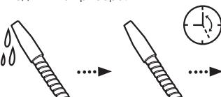
7. Откройте кран подачи воды в прибор, как только из шланга вывода потечёт вода, закройте кран и подождите 3-5 часов.
