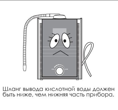
Шланг вывода кислотной воды должен быть ниже, чем нижняя часть прибора.
